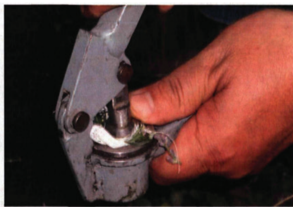
1-rasm. Qo'l press va u yordamida hujayra shirasini ajratish jarayoni.
